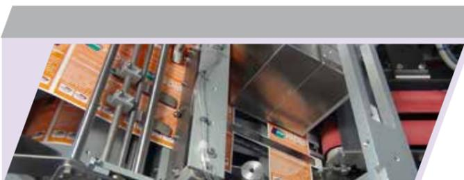
Il limitato spessore del materiale striped linerless in quanto privo del supporto siliconato e l'avanzamento del rotolo a passo corto, consentono una grande capacità dei rotoli di etichette e quindi una maggiore autonomia di funzionamento, riducendo i fermi linea per cambio del rotolo, aumentando la produttività
